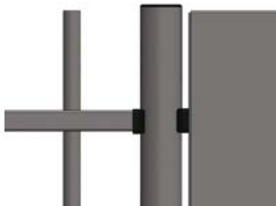
Onzichtbare verbinding en schroeven na montage niet meer te bereiken
