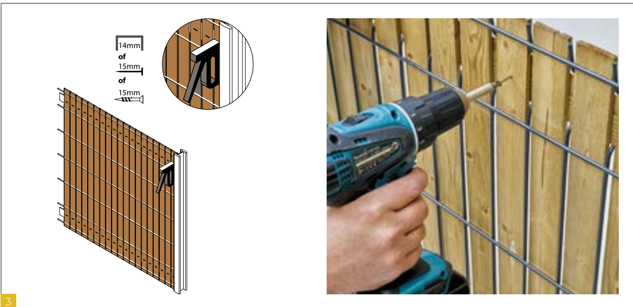
3 Bevestig elke lat aan de bovenste en onderste verstevigingbalk met inox spijkers van 15 mm of inox nietjes van 14 mm. ⚠ Spijkers en nietjes niet inbegrepen.
